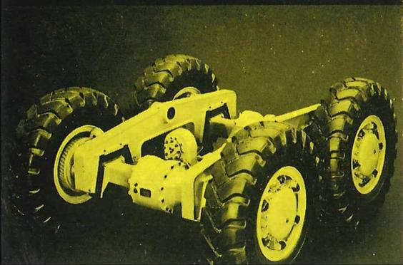
Die Planeten-Tandem-Achse ist federnd in Gummiblöcken gelagert. Die Bereifung 14.00 x 24 erlaubt im Straßentransport eine Belastung von 12 t je Achse bei normaler Fahrgeschwindigkeit.
