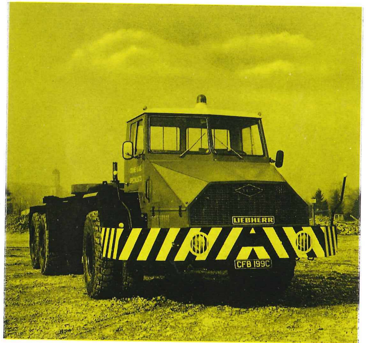
Sonderausführung AUK 120 mit doppelbereiften Vorder- und Hinterachsen. Gesamtbreite 3,33 m.
