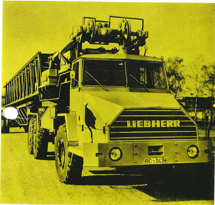
Standardausführung AUK 120 in Transportstellung
