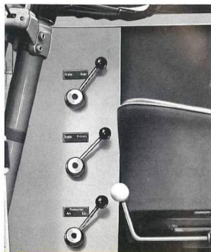
Vom Fahrersitz aus können alle Schaltungen für die einzelnen Antriebe leicht und übersichtlich ausgeführt werden. Eine Kontrolllampe auf dem Armaturenbrett zeigt jeweils an ob das Aggregat eingeschaltet ist.
