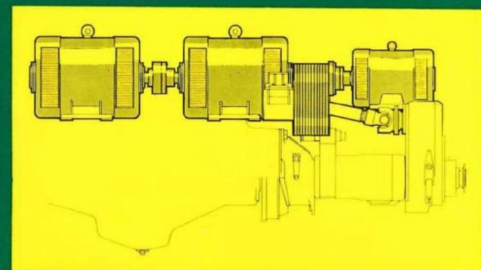
Die Stromerzeugung für das Kranfahren wird von 3 Generatoren vorgenommen. Der Antrieb erfolgt über Keilriemen vom Verteilergetriebe aus.
