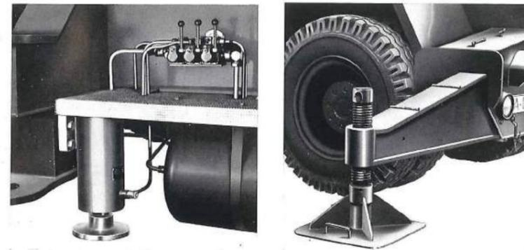
Die eingebaute hydraulische Abstützung ermöglicht ein schnelles und sicheres Abstützen des Kranes. Das gesamte Fahrzeug wird mit den hydraulischen Stempeln hochgedrückt und nivelliert, so daß die mechanischen Abstützspindeln nur noch festgedreht werden müssen.
