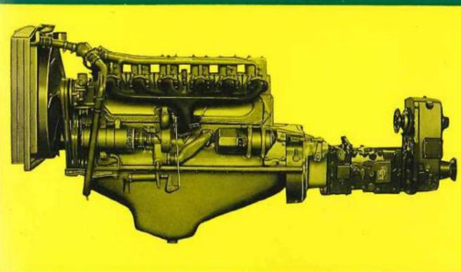
Ein wassergekühlter Dieselmotor mit angebaute Schalt- und Verteilergetriebe ist der Antrieb für Straße und Kran.
