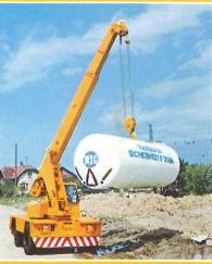
In Behälterfabriken und der chemischen Industrie transportiert der LI 1010 Tanks wie diesen und noch größere. Bis 8 t Eigengewicht.
