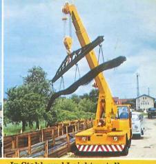
In Stahl- und Leichtmetallbetrieben sind Lagerarbeiten wie diese an der Tagesordnung: Der mobile Einsatz mit 2 t bei 6 m Ausladung.
