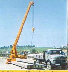
In Beton- und Fertigteilwerken kommt dieser Lastfall täglich vor: Der abgestützte Einsatz mit 2,5 t bei 7 m Ausladung.
