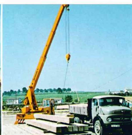
**In Beton- und Fertigteilverken kommt dieser Lastfall täglich vor: Der abgestützte Einsatz mit 2,5 t bei 7 m Ausladung.**
