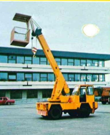
**Bei Schrottvwertung und Stahlerzeugung brauchen Sie Polypgreifer, Magnetplatte, Schalengreifer oder nur den Lasthaken. Und den LI 1012 mit Generator-Antrieb. Die Deutsche Bundesbahn kennt die Vielseitigkeit des LI 1012.**
