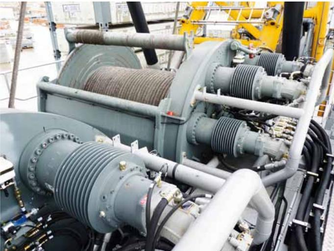
für ein Höchstmaß an Ausfallsicherheit und Wartungsfreundlichkeit. Bei Fehlfunktion kann ein Antrieb unter Last ausgetauscht werden.
