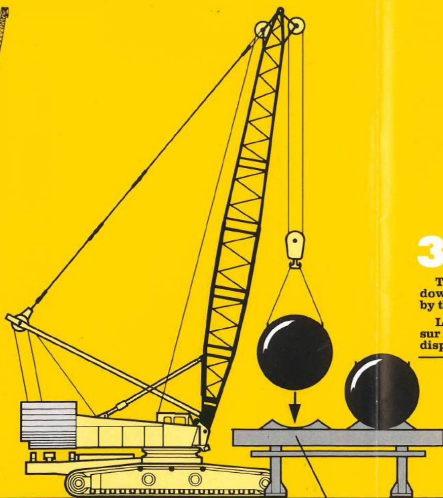
1 Der LR 1400 hebt vormontierte Bauteile auf die Lastenplattform. The LR lifts pre-assembled structural elements on to the load platform. La LR 1400 place des éléments préassemblés sur la plate-forme de chargement.
