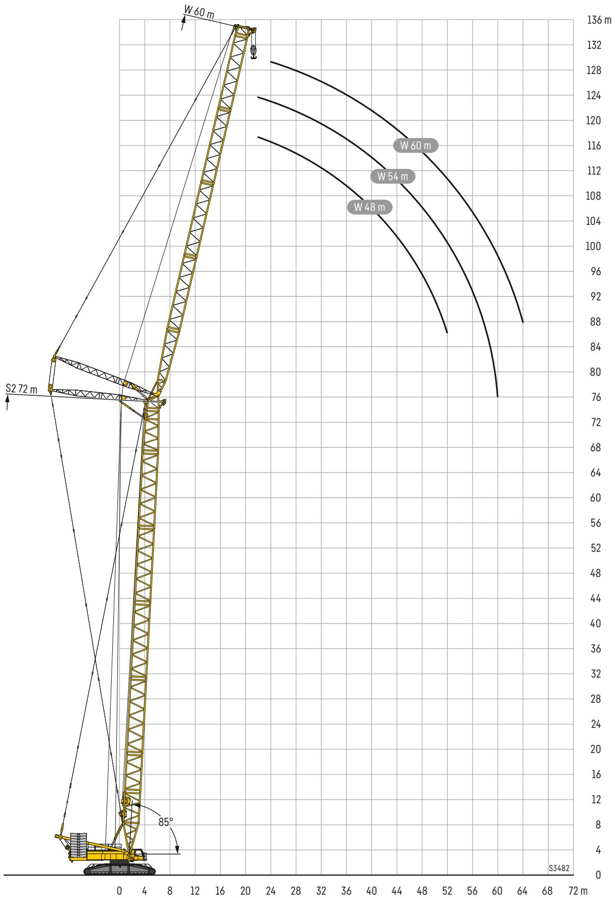
Lifting heights • Hauteurs de levage • Altezze di sollevamento • Alturas de elevación • Высота подъема
