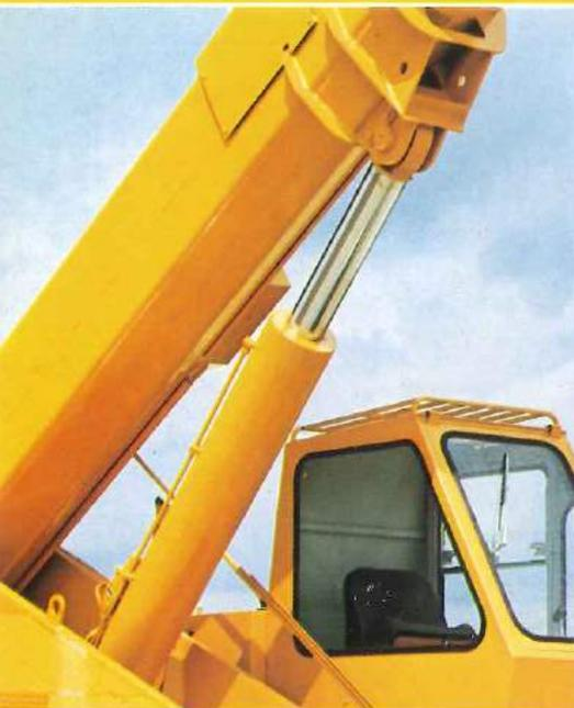
Der Wippzylinder bringt den Teleskarausleger in 80°-Stellung. Je steiler der Ausleger, desto höher die Traglasten.
