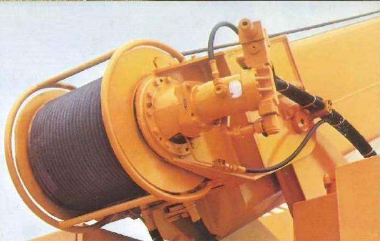
Über 120 m pro Minute Hubgeschwindigkeit und das mit Lasten bis 1.750 kg. Beim Betonieren wird das verlangt. Da kommt es auf die Seilwinde und das eingebaute Planetengetriebe an. Auf die Sicherheit und die Präzision, mit der die federbelastete Lamellenbremse arbeitet. Und auf den angeflanschten Ölmotor mit dem Hochleistungsgetriebe. Und auch auf den Endschalter für die 2 Sicherheitswindungen Seil.
