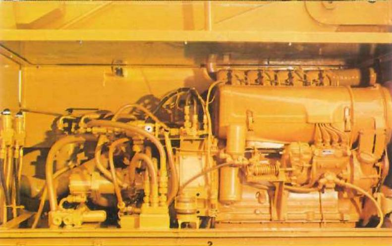
80 PS sind für den dieselhydraulischen Kranantrieb wirtschaftlicher als 192 PS. Und vollkommen ausreichend. Die Doppelgehäuse-Pumpe mit 2 eingebauten Axialkolben-einheiten ist summenleistungsgeregelt, d. h. die installierte Pumpenleistung verteilt sich nicht gleichmäßig auf die Verbraucher, sondern nach dem tatsächlichen Bedarf – wo viel Kraft gebraucht wird, steht viel Kraft zur Verfügung.
