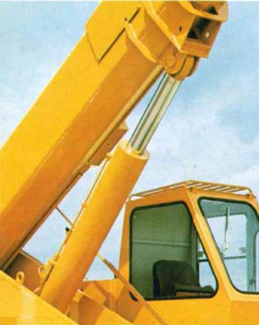
Der Wippzylinder bringt den Telesausleger in 80°-Stellung. Je steiler der Ausleger, desto höher die Traglasten.
