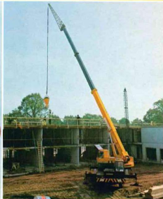
33 m Hubhöhe sind in dieser Kran-klasse keine Selbstverständlichkeit. Der LT 1025 hat für diese Höhe die 9 m lange starre Gitterspitze. Sie ist schnell montiert und mit dem Hilfshubwerk kann im 2-Haken-Betrieb gefahren werden.
