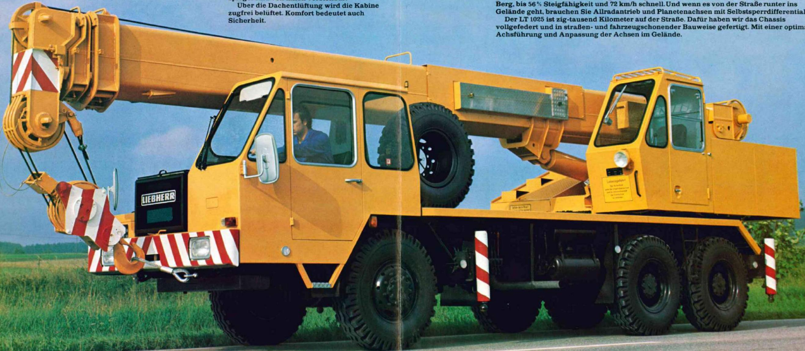
Vor dem Einsatz steht die Anfahrt. Da kommt es auf den starken Motor an: Er ist turbogeladen und hat Ladeluftkühlung und bringt 192 PS. Das bedeutet Durchzugskraft am Berg, bis 56% Steigfähigkeit und 72 km/h schnell. Und wenn es von der Straße runter ins Gelände geht, brauchen Sie Allradantrieb und Planetenachsen mit Selbstsperrdifferential.
