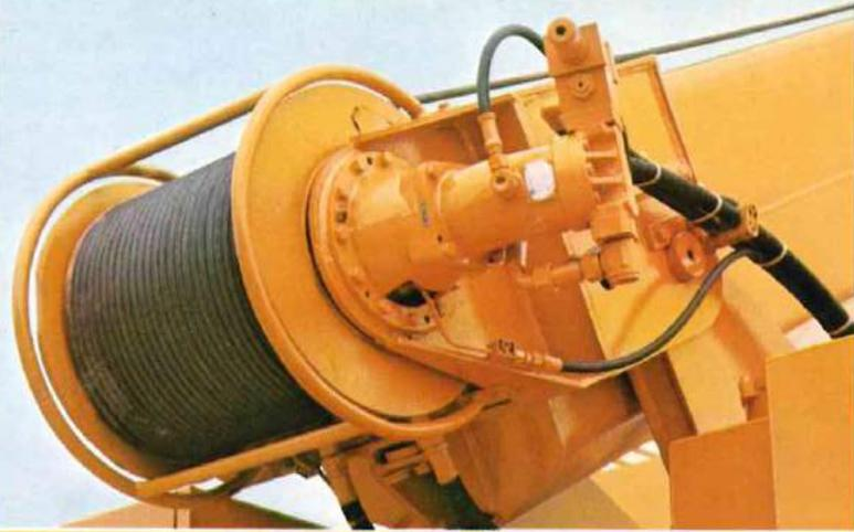
Über 76 m pro Minute Hubgeschwindigkeit und das mit Lasten bis 1.750 kg. Beim Betonieren wird das verlangt. Da kommt es auf die Seilwinde und das eingebaute Planetengetriebe an. Auf die Sicherheit und die Präzision, mit der die federbelastete Lamellenbremse arbeitet. Und auf den angeflanschten Ölmotor mit dem Hochleistungsgetriebe. Und auch auf den Endschalter für die 2 Sicherheitswindungen Seil.
