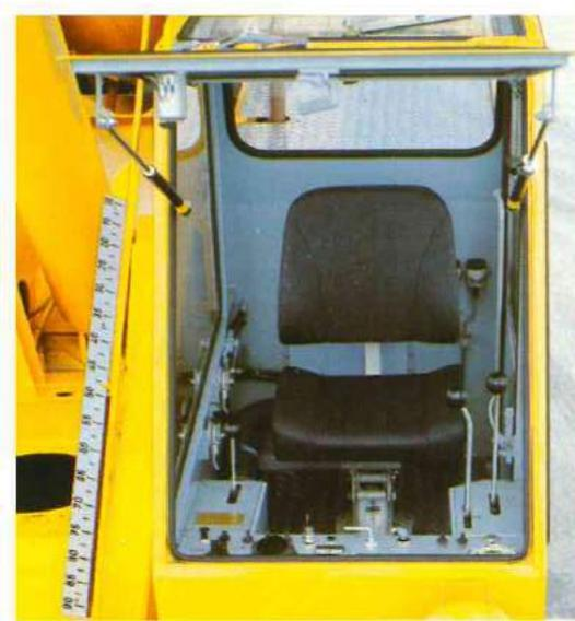
Wir machen es dem leicht, der schwer arbeiten muß. Innen ist die Kabine mit einem Dämmstoff ausgefacht: Für einen niedrigen Geräuschpegel.
