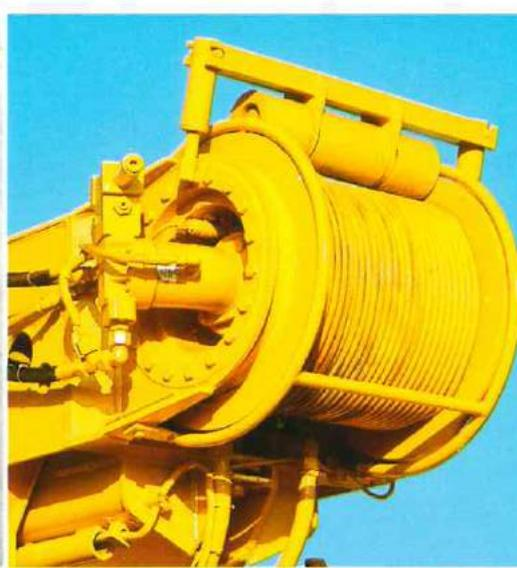
Bei über 75 m pro Minute Hubgeschwindigkeit kommt es auf die Seilwinde und das eingebaute Planetengetriebe an. Auf die Sicherheit und die Präzision, mit der die federbelastete Lamellenbremse arbeitet. Und auf den angeflanschten Ölmotor mit dem Hochleistungsgetriebe. Und auch auf den Endschalter für die 2 Sicherheitswindungen Seil.
