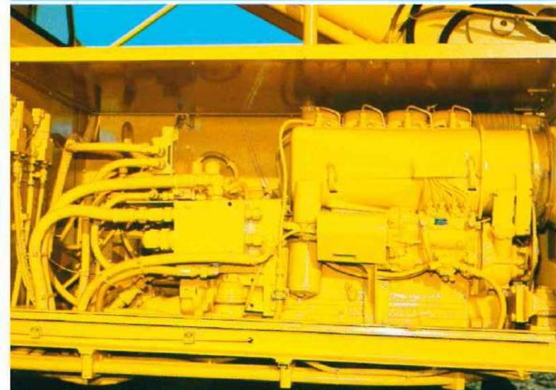
59 kW sind für den dieselhydraulischen Kranantrieb wirtschaftlicher als 140 kW. Und vollkommen ausreichend. Die Doppelgehäuse-Pumpe mit 2 eingebauten Axialkolbeneinheiten ist summenleistungsgeregelt, d.h. die installierte Pumpenleistung verteilt sich nicht gleichmäßig auf die Verbraucher, sondern nach dem tatsächlichen Bedarf – wo viel Kraft gebraucht wird, steht viel Kraft zur Verfügung.
