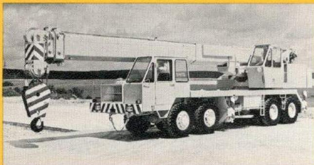
Da das Chassis in seiner Länge nur 9,7 m mißt und der Wenderadius dieses 4-achsigen Krans bei 12,5 m liegt, erfolgen die Positionierung des Gerätes am Bauwerk sowie der mehrfache Standortwechsel problemlos.
