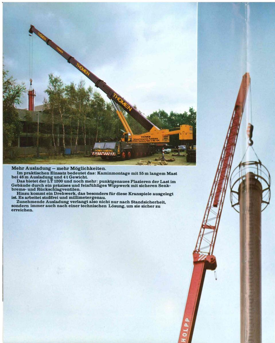
Im Kranoberwagen und am Teleskopausleger setzt sich der hohe technische Standard durch Verwendung erprobter und bewährter Bauelemente fort. In der Diesel-Hydraulik, der elektrohydraulischen Kransteuerung, dem prismatischen Auslegerprofil und dem hydro-mechanischen Teleskopiersystem zielen alle konstruktiven Maßnahmen auf gesteigerte Leistung und erhöhte Funktionssicherheit.
