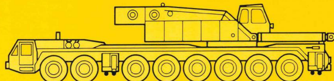
LT 1300 ohne Teleskopausleger in Transportstellung Gesamtgewicht: ca. 72 t (ca. 8 x 9 t) Fahrzeugbreite: 3 m Teleskopauslegertransport auf Tieflader. Gesamtgewicht: ca. 60 t (ca. 1 x 6 t + 6 x 9 t) Fahrzeugbreite: 2,5 m
