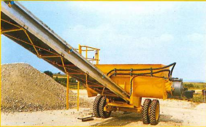
Zuführband mit großem Aufgabetrichter. Supply belt with large loading hopper. Tapis d'alimentation avec grande trémie d'alimentation.
