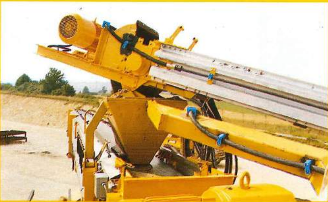
Drehvorrichtung mit Übergabe zum Hauptförderband. Swivel device with transfer to main conveyor belt. Joint tournant avec déchargement sur le tapis principal.
