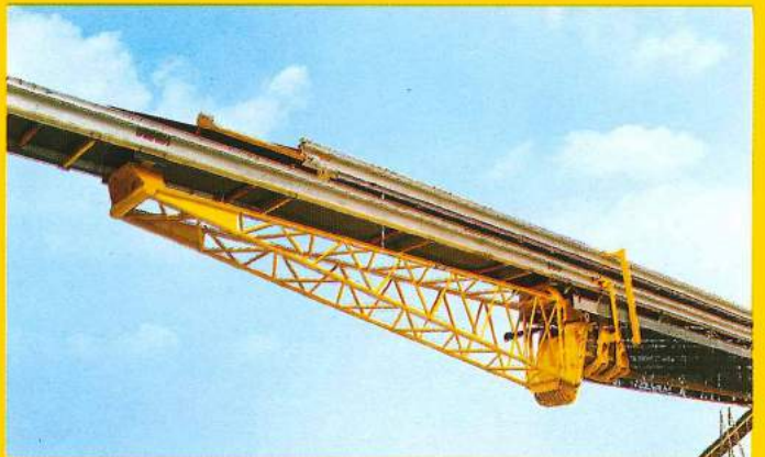
Halterungen am Teleskopausleger und an der Auslegerverlängerung. Mountings on crane's telescopic boom and on lattice boom extension. Fixation sur la flèche télescopique et la fléchette treillis rallonge.
