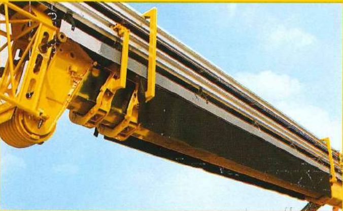
Teleskopierbare Vollkunststoff-Auslegerabdeckung als Spritzschutz. All-plastic telescopic boom cover to prevent splashing. Protection latérale de flèche télescopable en synthétique, (protection contre les projections).
