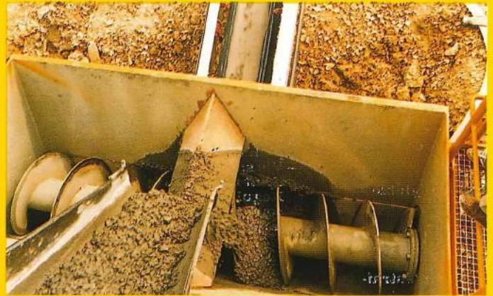
Hydraulisch angetriebene Förderschnecke im Aufgabetrichter. Hydraulically driven feed screw in loading hopper. Vis doseuse à entraînement hydraulique dans la trémie d'alimentation.
