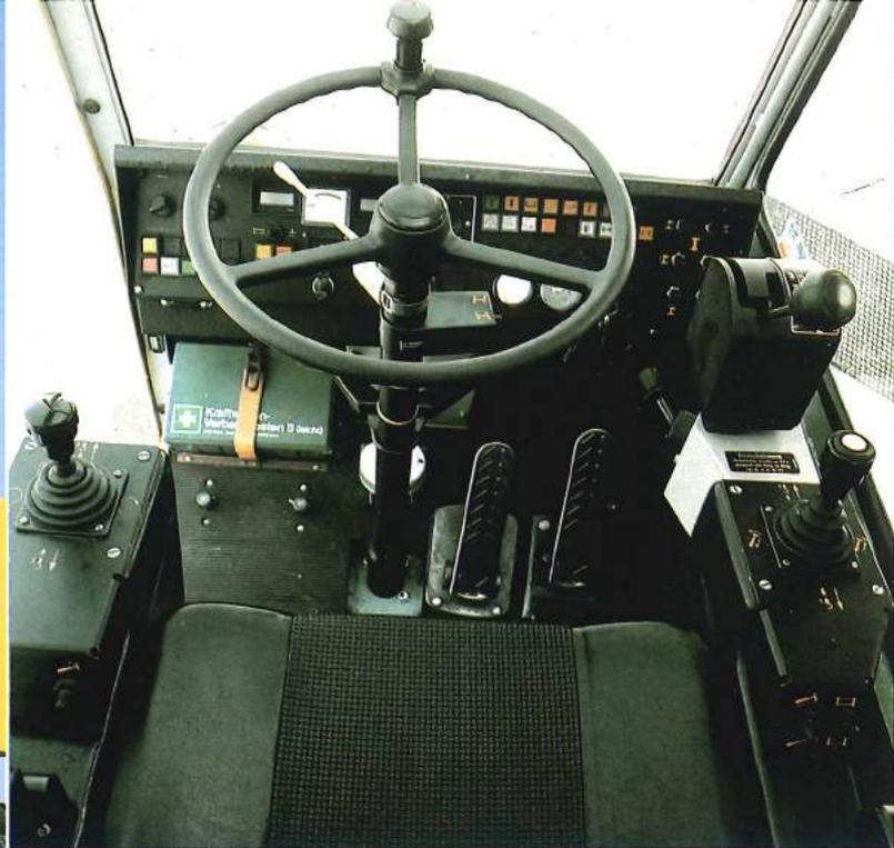
Rundumsicht bietet die geräumige Krankabine, aus der alle Fahr- und Arbeitsbewegungen gesteuert werden. Der Einstieg wird durch einen sicheren Aufstieg und die breite Schiebetüre erleichtert. Die Bedien- und Kontrollinstrumente sind standardisiert. Dies erleichtert dem Kranfahrer die Bedienung verschiedener Krangrößen, wenn einmal Not am Mann ist.
