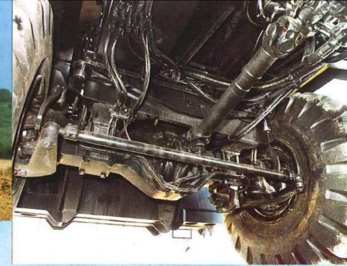
Die pendelnd aufgehängte Hinterachse wird beim Verahren von Lasten durch 4 Hydraulikzylinder blockiert. Sobald die Drehbühne aus der Längsrichtung schwenkt, erfolgt diese Achsverriegelung automatisch.
