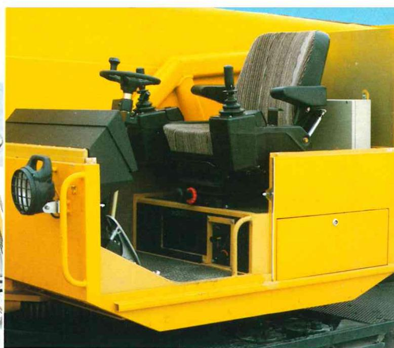
Platz, Übersicht und Komfort, sicheren Aufstieg und beste Rundumsicht bietet die vollverzinkte Liebherr-Krankabine. Colorverglasung, Panzerglas oben und Sicherheitsglas rundum, schallgedämpft und mit isoliertem Heizkanal, raumsparender Schiebetüre und moderne Armlehnensteuerung mit zuverlässiger Sitzkontaktschaltung sind weitere Merkmale, die den modernen Arbeitsplatz im LTM 1025 kennzeichnen. Neben den standardisierten Bedien- und Kontroll-
