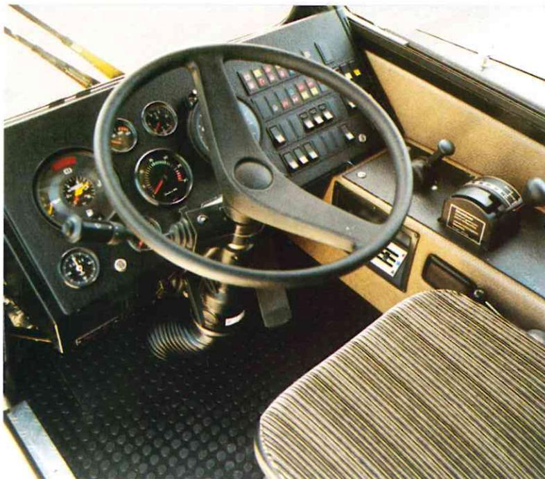
Das schmale oder auf Wunsch auch breite Fahrerhaus aus verzinktem Stahlblech ist schwingungsgedämpft gelagert und komfortabel ausgestattet. Mit hydraulisch gedämpftem, mehrfach verstellbarem Sitz, verstellbarem Lenkrad und übersichtlich angeordneten Bedienungs- und Kontrollinstrumenten. Zwei breite Schiebefenster, die Dachentlüftung und das leistungsstarke Gebläse sorgen für ein gutes Raumklima. Neben dem Einmann-Fahrerhaus im geräumigen Staukasten ist viel Platz für Anschlagmittel und Werkzeug.
