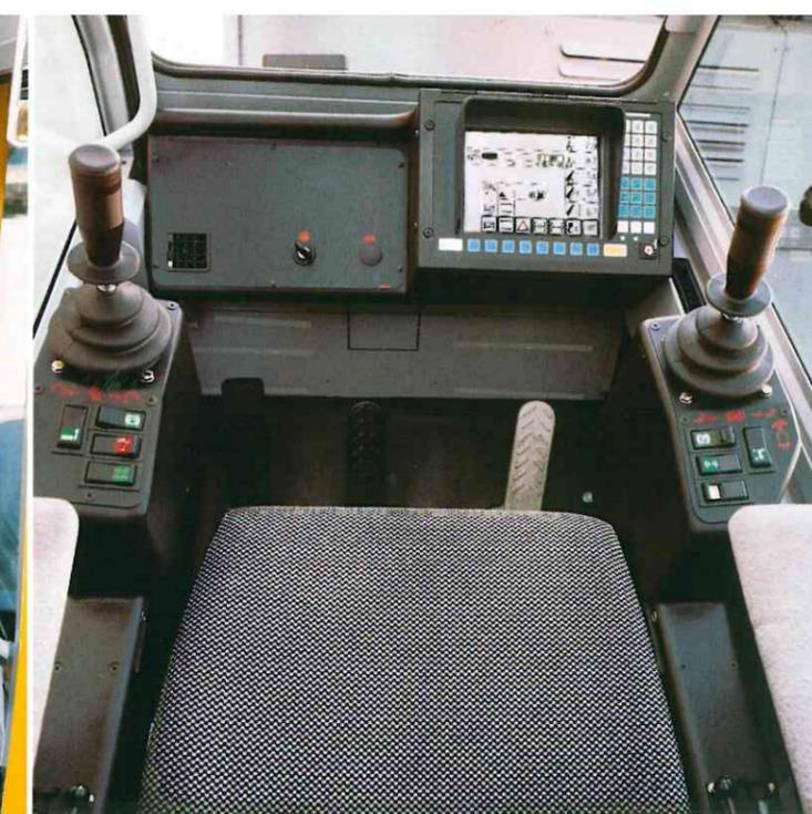
wahlweise über vier sichere Aufstiege und eine platzsparende Schiebetür. Gelenkt wird „von oben“ über Tastschalter. Das herkömmliche Lenkrad ist Vergangenheit; dadurch ergibt sich deutlich mehr Bewegungsfreiheit in der Kabine. Alle Zusatzfunktionen für Verfahren und Abstützen „von oben“ werden über den Liebherr-Systembus angesteuert. Die Funktionsanzeigen sind als Grafiksymbbole direkt auf dem LICCON-Bildschirm sichtbar. Mikroelektronik erhöht die Funktionalität und verbessert den Bedienkomfort.
