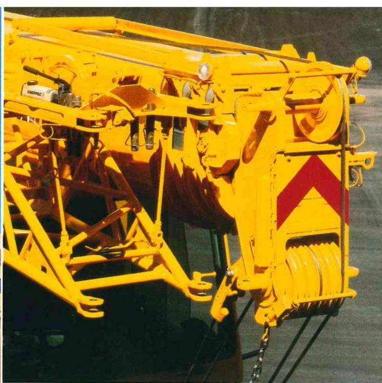
Mit der Entwicklung des neuen, ovalen Auslegerquerschnittsprofils mit den Mehrfachkantungen im Untergurt erfolgt eine optimierte Abstimmung des Teleskopauslegers auf die statischen und dynamischen Beanspruchungen mit dem Ziel einer Traglaststeigerung und Auslegerverlängerung. Über das bewährte 3stufige, hydromechanische Teleskopiersystem mit Hydraulikzylinder und 2fach-Flaschenzug werden die drei Teleskope immer synchron aus- bzw. eingeschoben.
