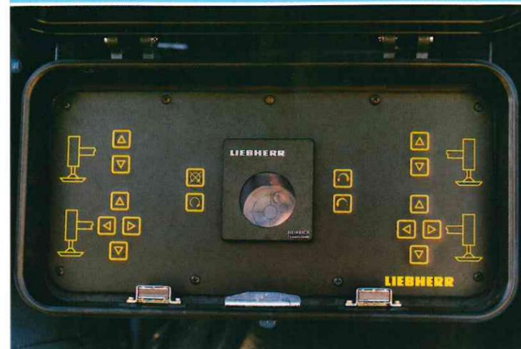
Der Kran kann wahlweise über zwei Steuertableaus am Fahrgestell oder aus der Krankabine abgestützt und einnivelliert werden. Die Bedieneinheiten sind an den Liebherr-Systembus angeschlossen und werden von Modulen angesteuert. Die Tableaus befinden sich schmutzgeschützt in verschließbaren Kunststoffkästen seitlich am Fahrgestell. Die Folientastatur und die Spiegellibelle sowie die Taster für Motor STOP/START und Drehzahlregulierung sind beleuchtet. Die Abstützplatten können
