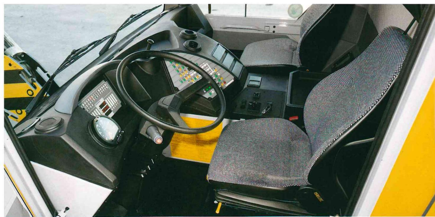
Durch eine Kataphorese-Tauchgrundierung erhält das Fahrerhaus des LTM 1030/2 einen hervorragenden Korrosionsschutz. Die neugestalteten Armaturenräger sind übersichtlich und bedienerfreundlich im Halbrund angeordnet. Die digitalen Anzeigeneinheiten u.a. mit den Kontrollleuchten mit Verschwindeffekt für die verschiedenen Fahrzustände und den Analoganzeigen sowie die Tastatureinheit mit der dimmerbaren Beleuchtung arbeiten nicht nur zuverlässig, weil es weniger elektrische
