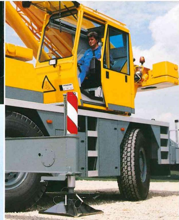
Über vier im Chassis fest integrierte Aufstiege kann der Kranfahrer seinen Arbeitsplatz sicher erreichen. Das Verfahren und Abstützen aus der Krankabine gehört zur Standardeinrichtung. Beide Achsen werden über Tastschalter gelenkt; durch den Wegfall des Lenkrades erhöht sich das Raumangebot in der Kabine ganz erheblich.
