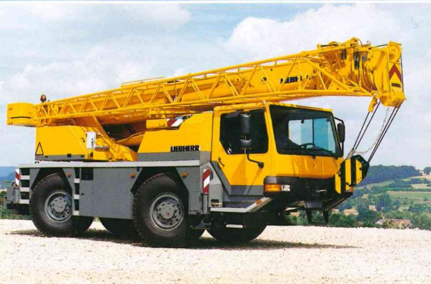
Am LTM 1030/2 dienen die großflächigen und glatten Verkleidungen nicht nur einer guten Optik, sondern sie vermindern auch Schmutzablagerungen in Ecken und sind darüber hinaus ein wirksamer Schutz gegen Kanten und Quetschstellen. Mit den elektrisch verstellbaren und beheizten Außenspiegeln und dem serienmäßigen Weitwinkelspiegel hat der Fahrer sein Umfeld stets im Blick.
