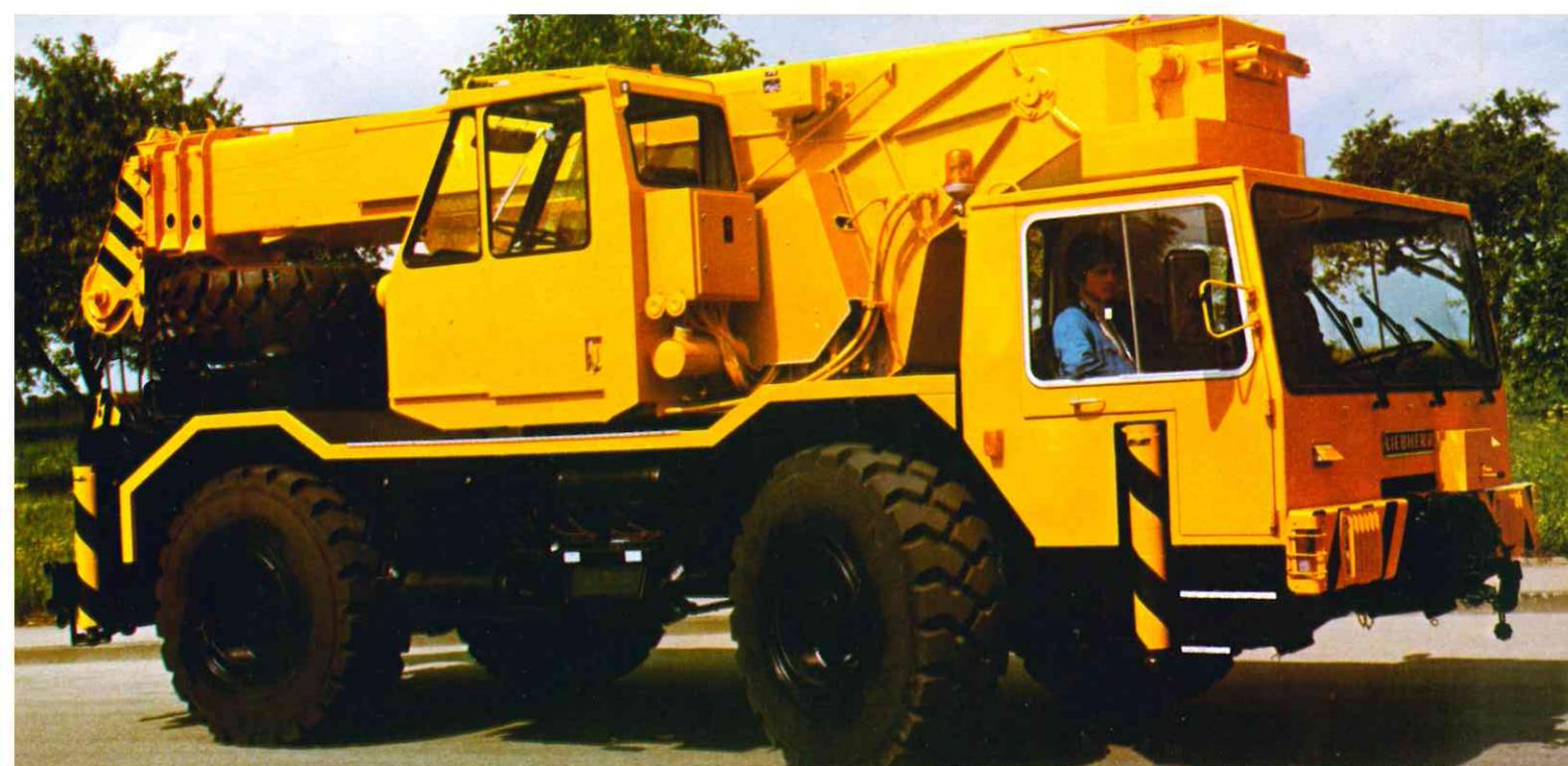
Als „Bergekran“ hat der LTM 1030 eine Sonderausrüstung: Beim Motor gibt es Varianten hinsichtlich Fabrikat und Leistung. Bergungswinden am Chassis mit bis 10 t Zugkraft sind für den Bergeinsatz Voraussetzung.
