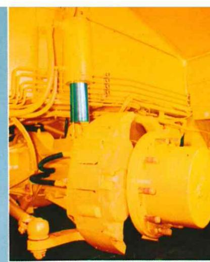
In „Straßenausführung“ sind beide Achsen hydro-pneumatisch gefedert.
