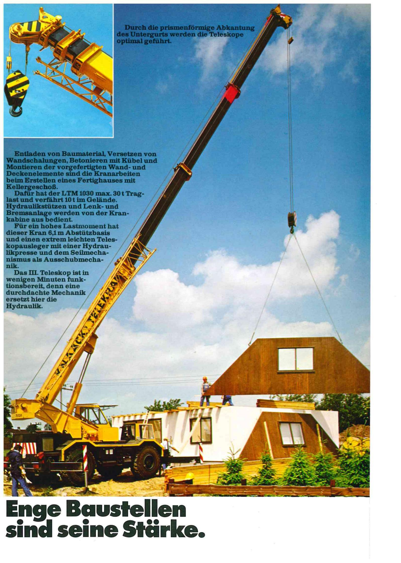
Durch die prismenförmige Abkantung des Untergurts werden die Teleskope optimal geführt.
