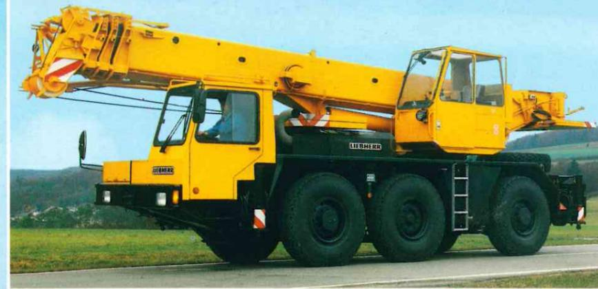
Beim LTM 1035-3 liegen die Achsdrücke je nach Ausrüstung zwischen 8 und 11 Tonnen und die Transportgewichte zwischen 24 und 31 Tonnen.
