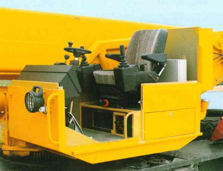
Mit einer Durchfahrtshöhe von 2,95 m ist der LTM 1035 der niedrigste Mobilkran in seiner Klasse. Erreicht wird dieses Maß mit der Standardbereifung, der Niveaumatik-Federung zum Absenken des Fahrzeugs und der Vario-Krankabine mit abnehmbarem Oberteil.
