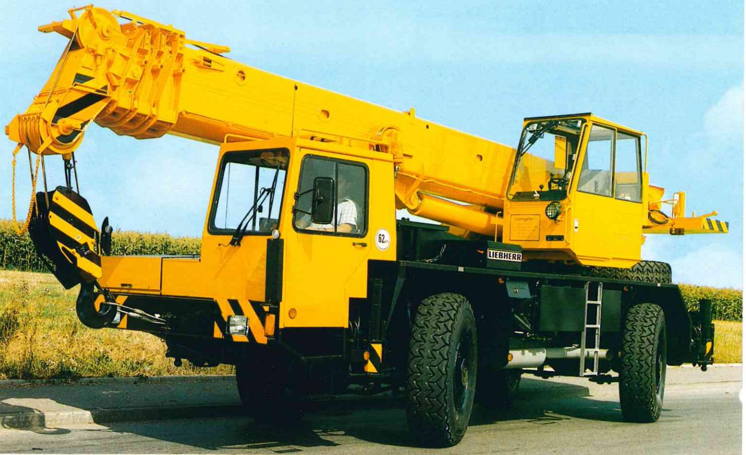
Mit dem variablen Ballast bleibt auch der LTM 1040-2 mit 2-Achs-Fahrgestell unter 24 t Gesamtgewicht. Die Ausstattung reicht für diesen 2-Achser vom Allradantrieb und der Allradlenkung, der Niveaumatik-Federung mit Programmsteuerung und der Standard- oder großvolumigen Geländebereifung bis hin zum 26 m oder 30 m langen Teleskopausleger.
