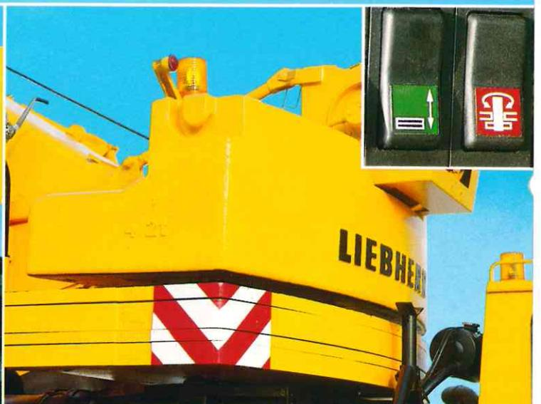
Fortschritt im Detail: Die Ballastmontage ist zum Beispiel eine Sache von Minuten und erfolgt aus der Krankabine. Kran schwenken, Oberwagen verriegeln, Hubzylinder über Tastschalter ausfahren, Drehbolzen über Tastschalter mit der Grundplatte verriegeln und Zusatzballast aufnehmen. Schneller geht's nicht mehr.
