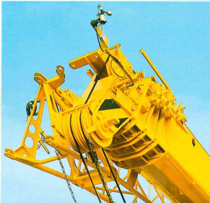
Haupthubwerk und Hilfshubwerk (Zusatzausstattung) arbeiten mit 42 kN Seilzug. Die Winden sind baugleich mit innenliegenden Planetengetrieben und verschleißlosen Lamellenbremsen. Der Windenantrieb erfolgt über moderne Axialkolben-Konstantmotore. Bei Bedarf kann das Hubwerk 2 abgebolzt werden.
