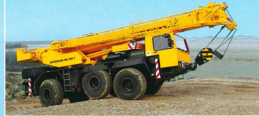
Durch Anheben der nichtangetriebenen zweiten Achse verbessert sich die Geländetauglichkeit des 40-Tonnners.
