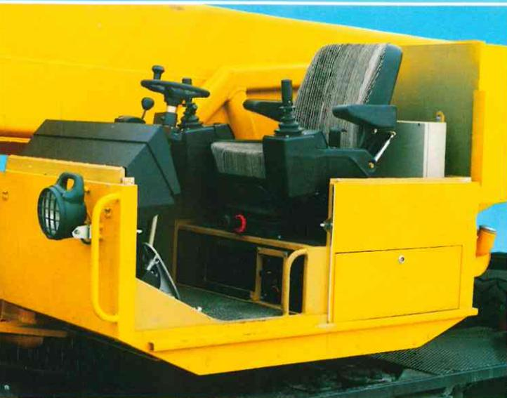
Mit einer Durchfahrthöhe von 2,95 m ist der LTM 1040 der niedrigste Mobilkran in seiner Klasse. Erreicht wird dieses Maß mit der Standardbereifung, der Niveaumatik-Federung zum Absenken des Kranaufbaus und der Vario-Krankabine mit abnehmbarem Oberteil.
