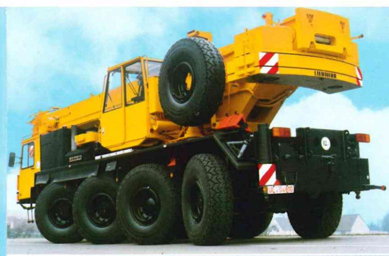
Das LTM-Konzept ist sichtbar: Kompakte Bauweise aktives Federungssystem, Böschungswinkel bis 25°, Allradlenkung, großvolumige Bereifung.
