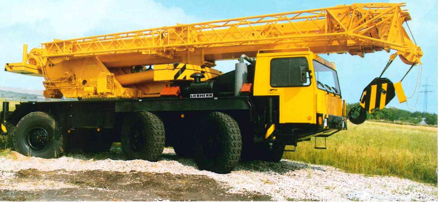
Von dem 3achsigen Mobilkran LTM 1050-3 sind über 200 Geräte im Einsatz. Die individuelle Ausrüstung dieses 50-Tonnners läßt keine Wünsche offen: Standard sind der Allradantrieb mit Differentialsperren, die Niveaumatik-Federung mit Programmsteuerung zum Heben, Senken, Kippen und Stabilisieren des Krans, die Fahr-
