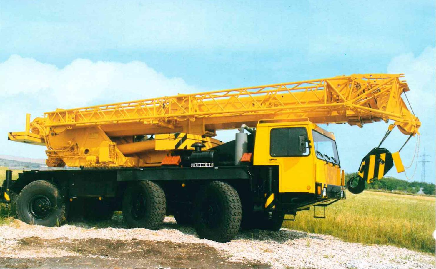
Von dem 3achsigen Mobilkran LTM 1050-3 sind über 200 Geräte im Einsatz. Die individuelle Ausrüstung dieses 50-Tonnners läßt keine Wünsche offen: Standard sind der Allradantrieb mit Differentialsperren, die Niveaumatik-Federung mit Programmsteuerung zum Heben, Senken, Kippen und Stabilisieren des Krans, die Fahr-
