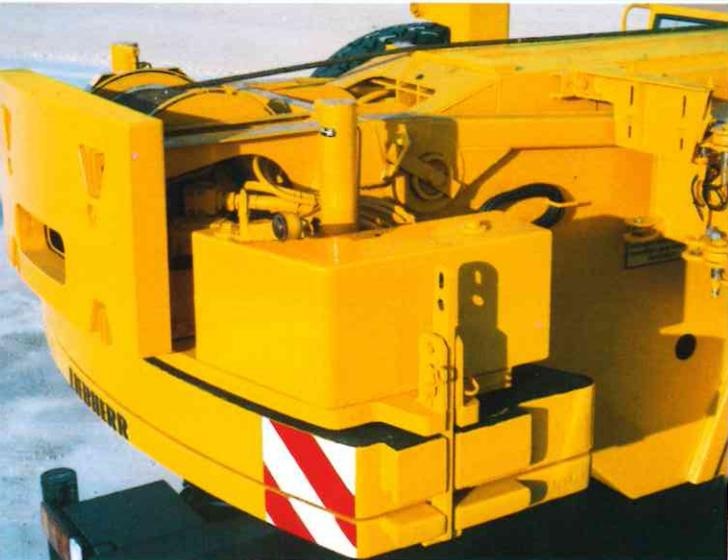
Je nach zulässigem Transportgewicht gibt es Ballastvarianten zwischen 1,7 t Teil- und 7,3 t Gesamtballast. In Transportstellung wird Teilballast zur Erzielung gleichmäßiger Achsdrücke auf dem Fahrgestell abgelegt.
