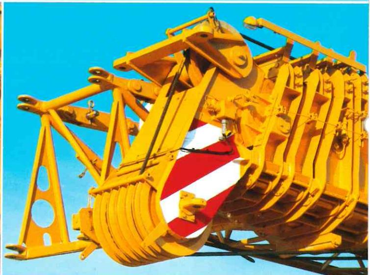
Der 38 m lange, 5teilige Teleskopausleger wird über ein leichtes hydromechanisches Teleskopiersystem mit 2 Hydraulikzylindern und 2fach-Flaschenzug teleskopiert. Das prismatische Auslegerprofil mit 2fach-Kantung im Untergurt ist beulsteif und besitzt präzise Führungseigenschaften. Die Teleskopschübe gleiten auf wartungsfreien Polyamidplatten.
