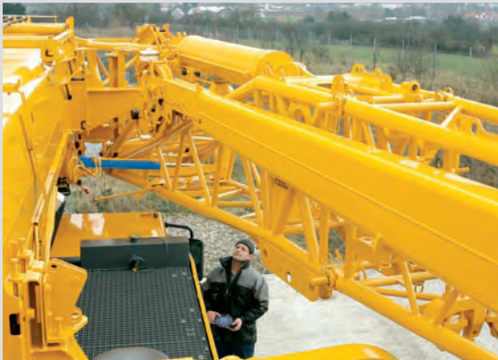
Hydraulische Montagehilfe zum Anbau der Klappspitze mit BTT
