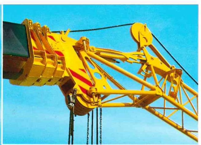
Die max. 18 m lange Doppelklappspitze wird unter 0°, 15° oder 30° angebolzt. Für die Montage sind nur wenige Handgriffe erforderlich. Besonders bedienerfreundlich ist die automatisch verriegelnde Pendelrückfallstütze und die hydraulische Montagehilfe.
