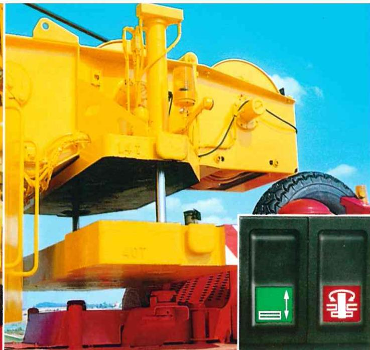
Die Ballastmontage ist eine Sache von Minuten: Zusatzballast mit dem eigenen Haken vom Begleitfahrzeug aufnehmen und auf dem Fahrgestell ablegen, Oberwagen mit Teilballast darüber schwenken und den Zusatzballast über die Ballastierzylinder aufnehmen. Der komplette Vorgang wird aus der Krankabine gesteuert.
