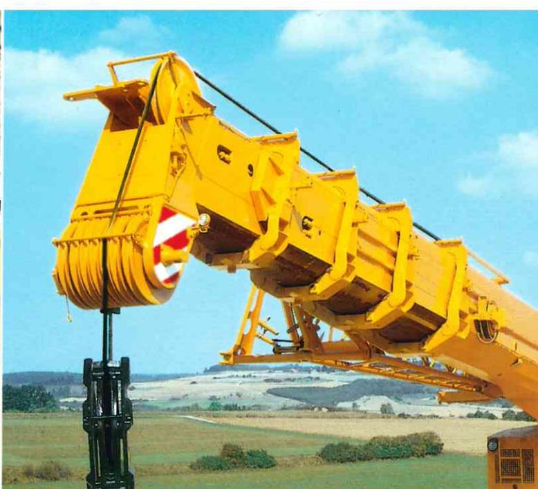
Der 5teilige, 45 m lange Teleskopausleger wird über zwei Zylinder und einen 2fach-Seilzug teleskopiert. Dieses hydromechanische Teleskopiersystem verlagert den Schwerpunkt des ausgefahrenen Auslegers zum Auslegerfuß und wirkt somit traglaststeigernd.
