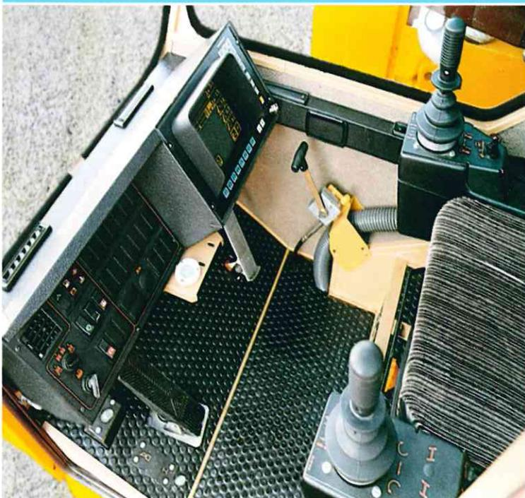
Die vollverzinkte Krankabine entspricht der NEN-Norm und damit internationalem Standard. Der Komfort-Kranführersitz mit Kopfstütze und automatischer Gewichtseinstellung ist luftgefedert, die Steuergerberkonsolen sind höhen- und längsverstellbar. Sicherheitsverglasung, getönte Seitenscheiben und Sonnenschutzrollo sind Teil eines ausgesuchten Interieurs, das keine Wünsche offen läßt. Fahren, Lenken und Abstützen aus der Krankabine gehören zur Zusatzausstattung.
