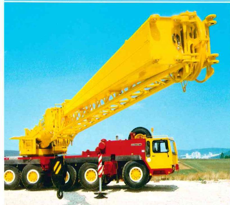
Zusatzausleger erweitern den Arbeitsbereich. Beim LTM 1090 mißt die Doppelklappspitze 11,3 bis 20 m. Sie wird unter 0°, 15° oder 30° montiert. 67 m Hubhöhe und 52 m Ausladung kennzeichnen den Arbeitsbereich.
