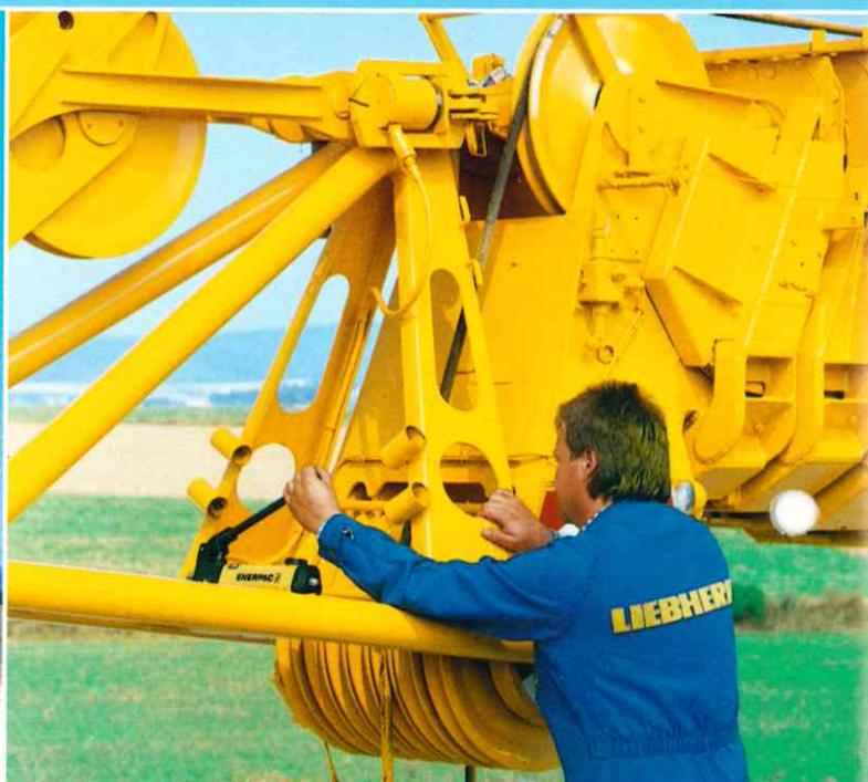
Jetzt gibt es bei Liebherr die hydraulische Montagehilfe, um die Klappspitze im Einmannbetrieb mühelos zu montieren. Hierzu wird die Spitze aus ihrer Verriegelung gelöst, umgeschwenkt und mit der Rollenkopfachse am Auslegerkopf verbolzt. Über eine hydraulische Handpumpe wird die Gitterspitze dann an das Auslegerkopfstück herangezogen und der obere Bolzen kann mühelos gesteckt werden.
