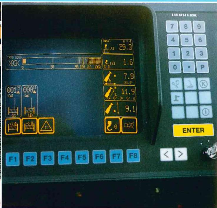
Die LICCON-Überlastanlage bietet ein faszinierendes Angebot an Sicherheit und Komfort. Auf dem Bildschirm wird für jeden möglichen Rüstzustand die dazugehörige Traglasttabelle dargestellt. Das Betriebsbild informiert über die Kranauslastung und die gesamte Krangeometrie. Und bei Überlast ist die LICCON die zuverlässige Abschalteneinrichtung.
