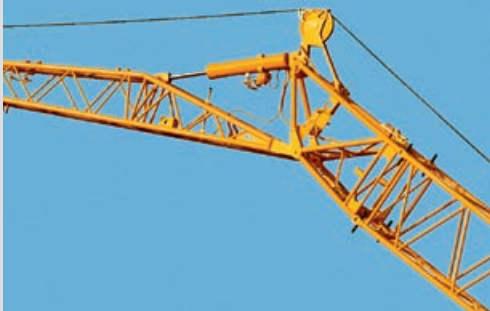
Hydraulisch verstellbare Klappspitze (0° – 40°)
