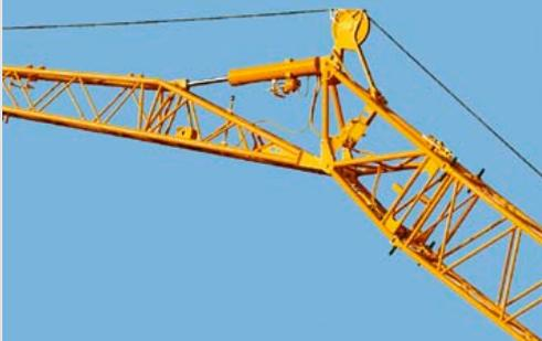
Schlauchtrommel für Hydraulikzylinder
