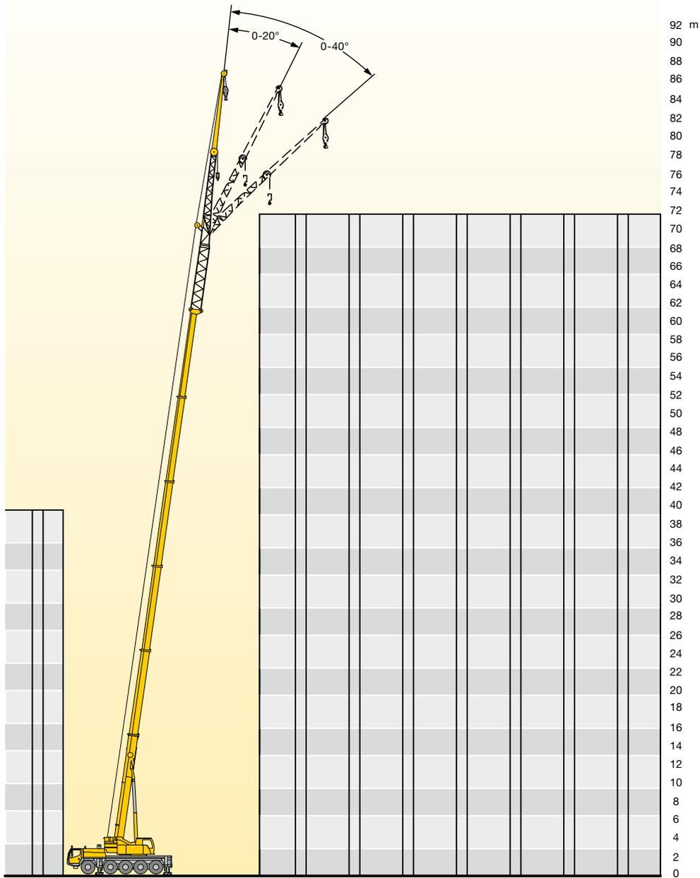
Hydraulisch verstellbare Klappspitze (0° – 40°)
