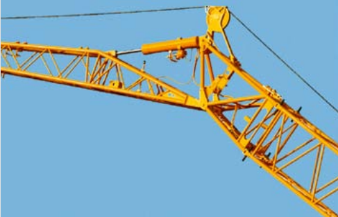
Hydraulisch verstellbare Klappspitze (0°- 40°)
