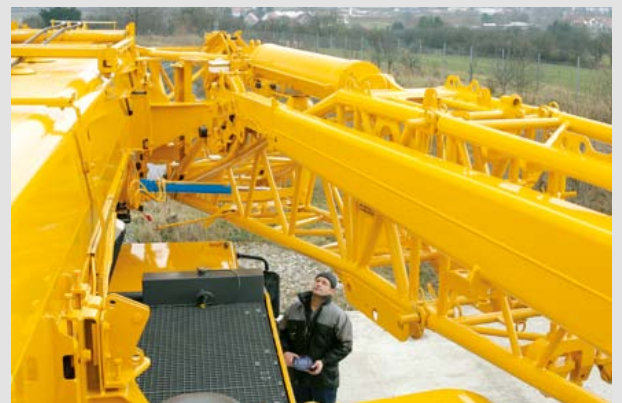
Hydraulische Montagehilfe zum Anbau der Klappspitze mit BTT
