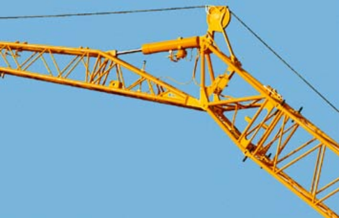
Hydraulisch verstellbare Klappspitze (0° – 40°)
