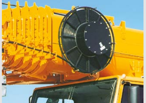
Schlauchtrommel für Hydraulikzylinder
