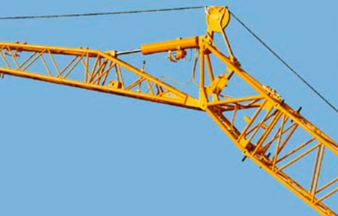
Hydraulisch verstellbare Klappspitze (0° – 40°)
