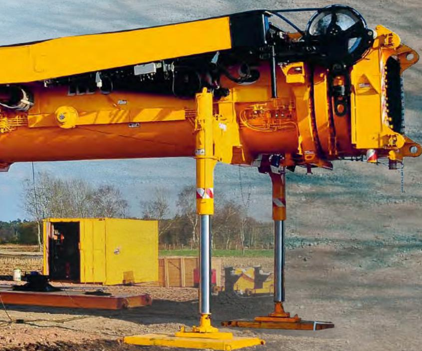
Die Montage des Auslegers auf der Baustelle erfolgt optional ohne Hilfskran. Mit vier speziellen Abstützzy lindern stützt sich der Ausleger so ab, dass der Tieflader wegfahren und das Fahrgestell des LTM 11200-9.1 wahlweise vor- oder rückwärts unter dem Ausleger positioniert werden kann. Der Ausleger kann nun mit wenigen Handgriffen auf das Fahrgestell montiert werden.
