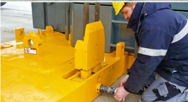
Einfache Verbolzung der Grundplatte mit Ballastervorrichtung
