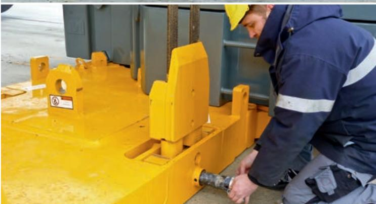
Einfache Verbolzung der Grundplatte mit Ballastvorrichtung
