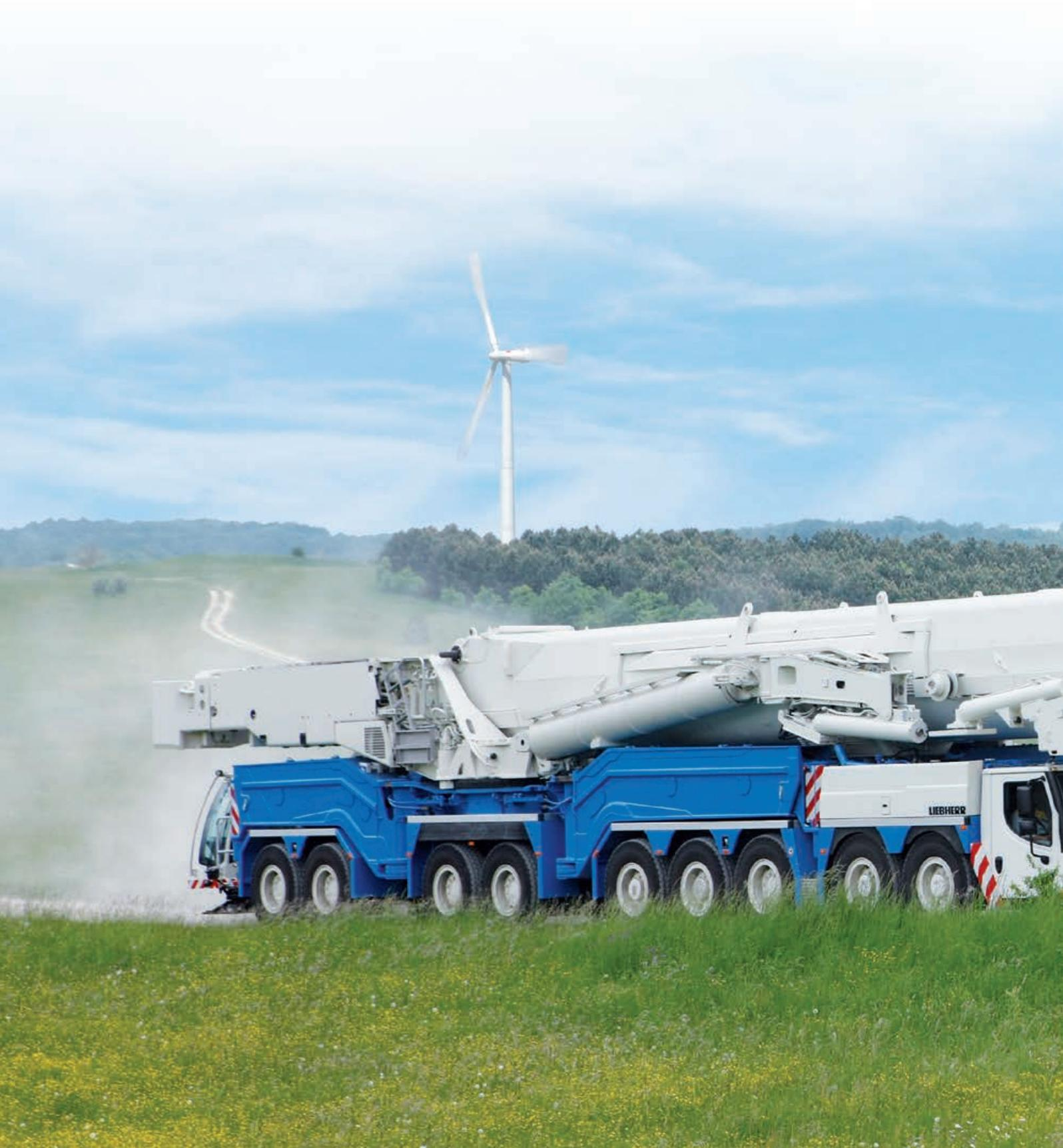
Der LTM 11200-9.1 ist mit 1.200 t Tragkraft der stärkste Teleskop-Mobilkran auf dem Markt und bietet den weltweit längsten Teleskopausleger. Beachtliche Traglaststeigerungen werden mit der Y-Teleskopausleger-Abspannung erreicht. Kurze Rüstzeiten, eine außergewöhnliche Mobilität sowie eine umfassende Komfort- und Sicherheitsausstattung zeichnen den Mobilkran LTM 11200-9.1 von Liebherr aus.
