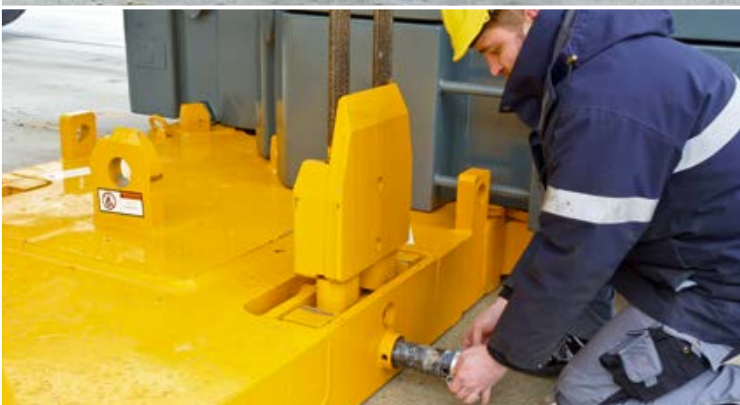
Einfache Verbolzung der Grundplatte mit Ballastvorrichtung
