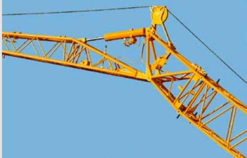
Hydraulisch verstellbare Klappspitze (0°- 40°)
