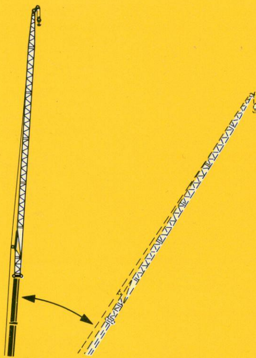
TK-Auslegersystem: T: 40,1 m - 48,9 m, K (0°): 14 m - 49 m Gesamtauslegerlänge: 98 m
