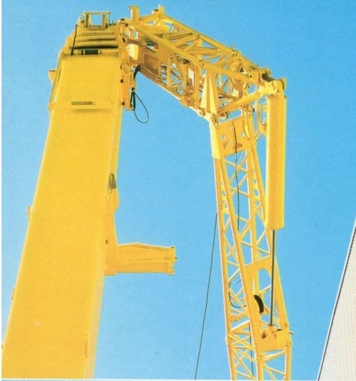
**Schwenkzylinder über Fernbedienung aktivieren und Klappspitze seitlich umklappen.**
