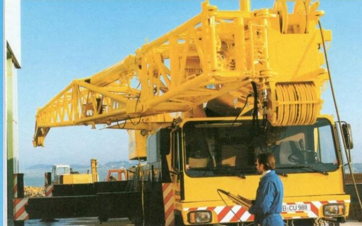
Klappspitzenkonsole entsichern und ausschwenken. Klappspitze am Drehpunkt vom Teleskopausleger-Anlenkstück entriegeln und über Fernbedienung weiter ausschwenken; die Spitze bleibt jedoch innerhalb der Abstützbasis des Krans.
