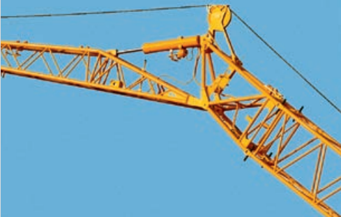
Hydraulisch verstellbare Klappspitze (0° - 45°)
