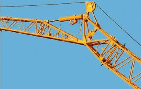
Schlauchtrommel für Hydraulikzylinder
