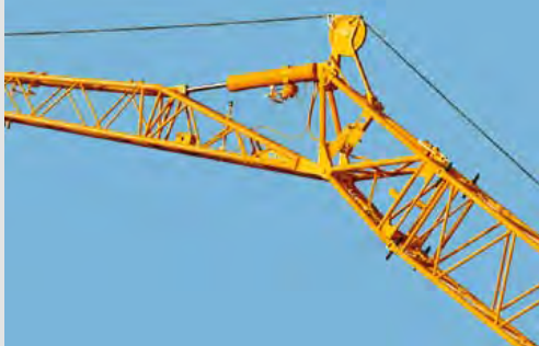
Hydraulisch verstellbare Klappspitze (0°- 45°)
