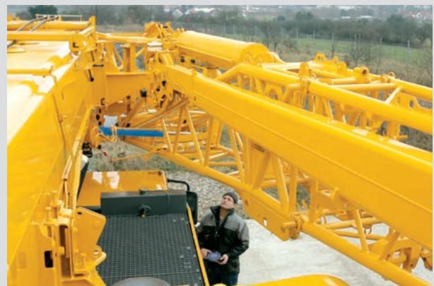
Hydraulische Montagehilfe zum Anbau der Klappspitze mit BTT
