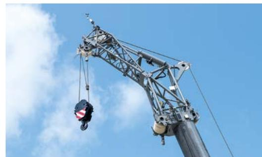
Hydraulisch verstellbare Klappspitze (0° bis 40°)
