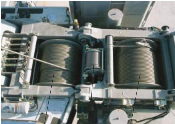
**Winde 1**   **Hilfswinde**   **Winde 2**
