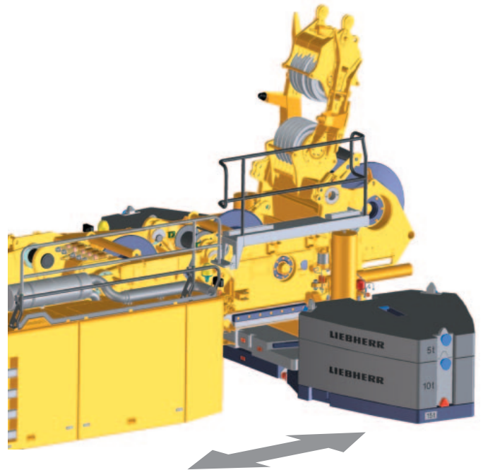
Wippspitzenbetrieb, Ballastradius 5,6 m oder 6,6 m
