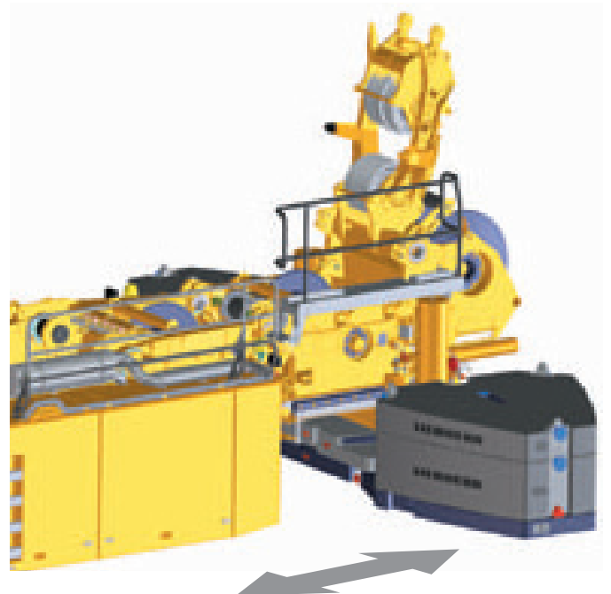
Wippspitzenbetrieb, Ballastradius 5,6 m oder 6,6 m
