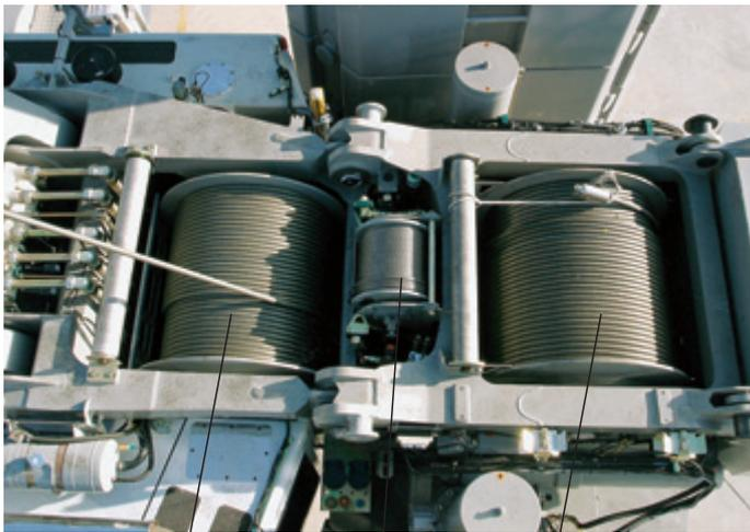
**Winde 1    Hilfswinde    Winde 2**
