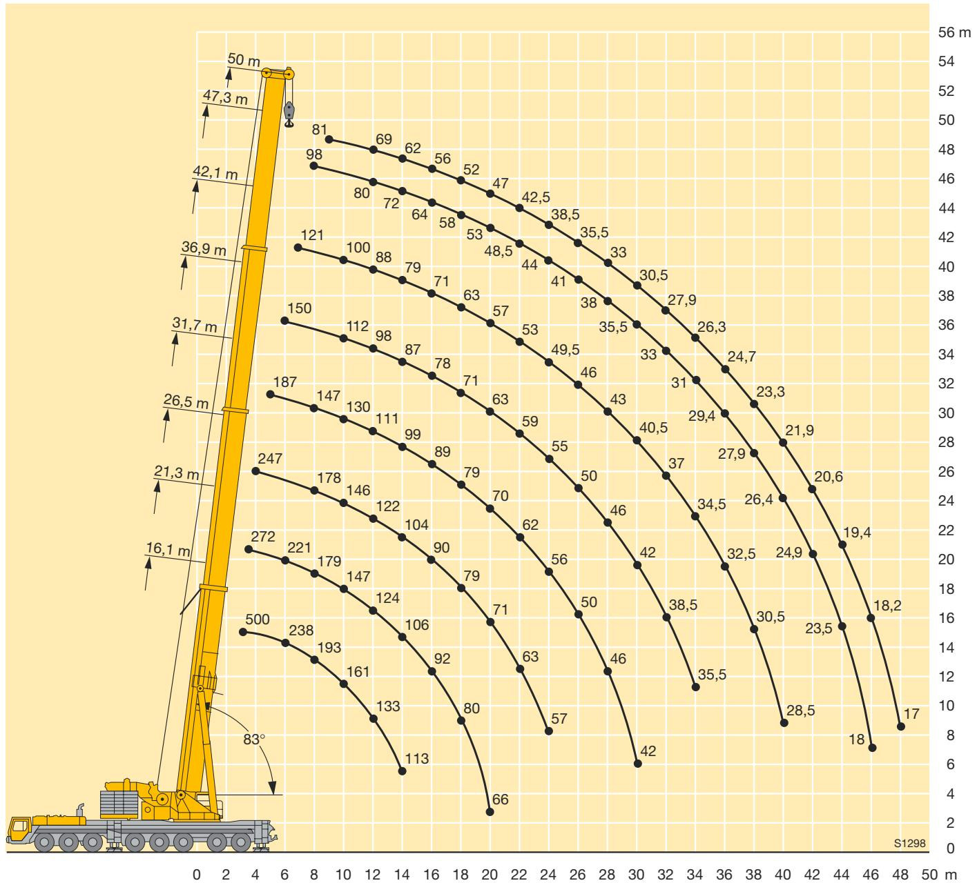
**Traglasten am abgespannten Teleskopausleger**
