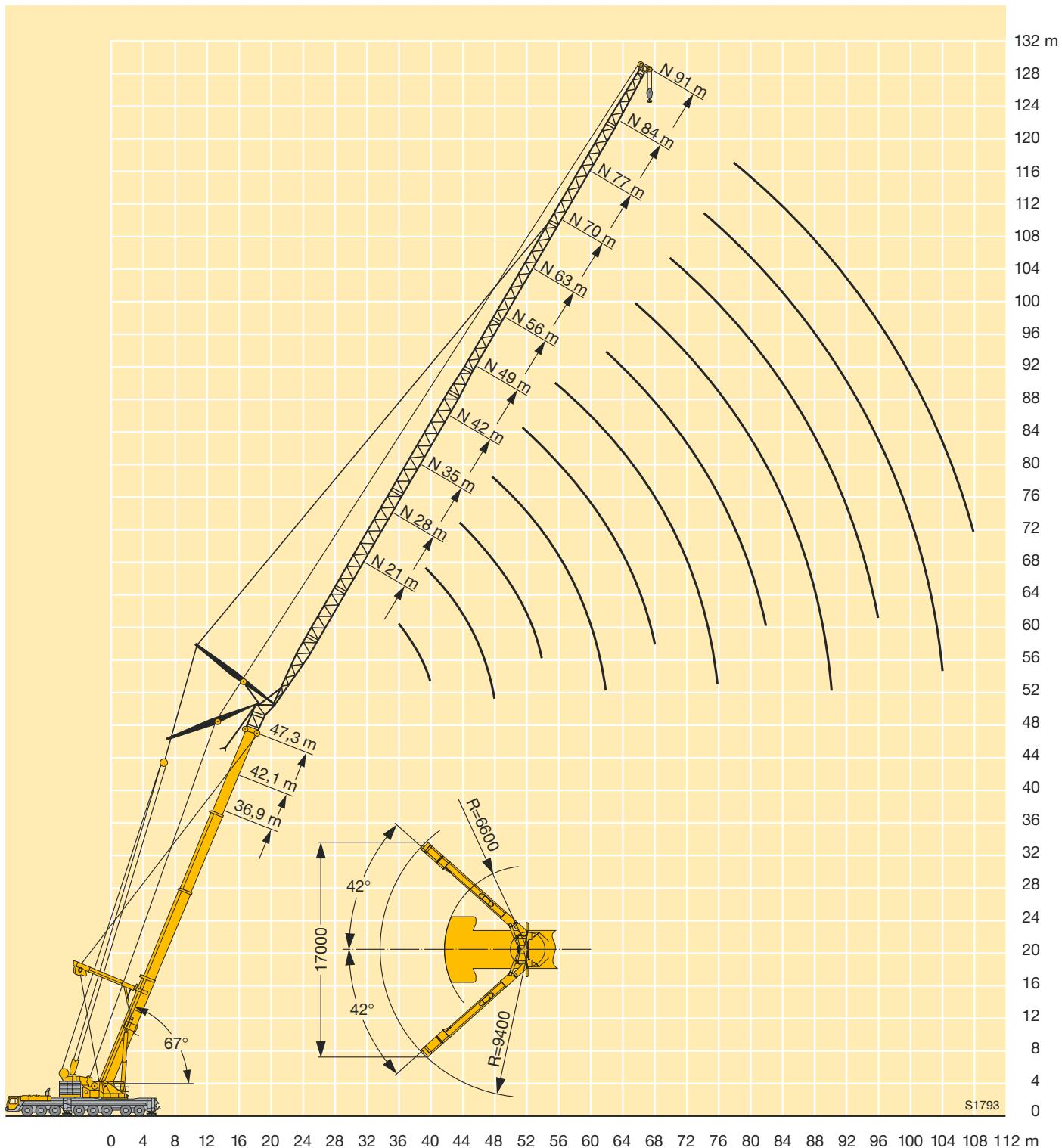
**Traglasten an der wippbaren Gitterspitze mit
