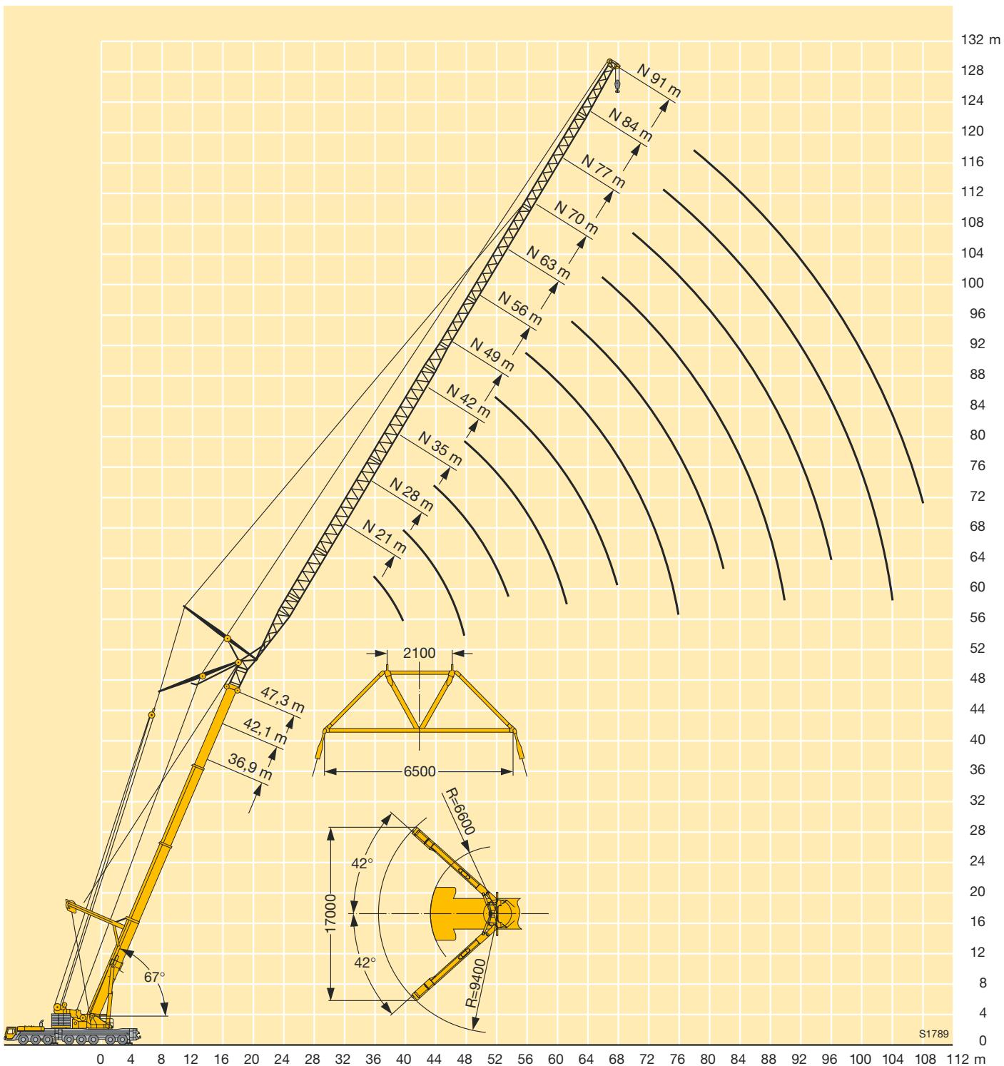
**Traglasten an der hydraulisch verstellbaren festen Gitterspitze**
