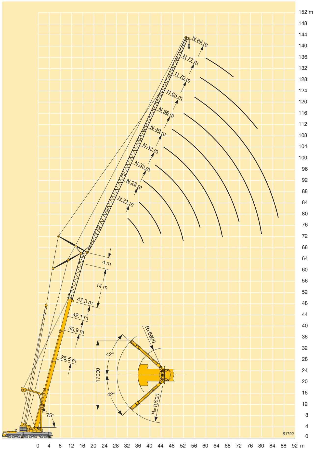
**Traglasten an der wippbaren Gitterspitze mit
