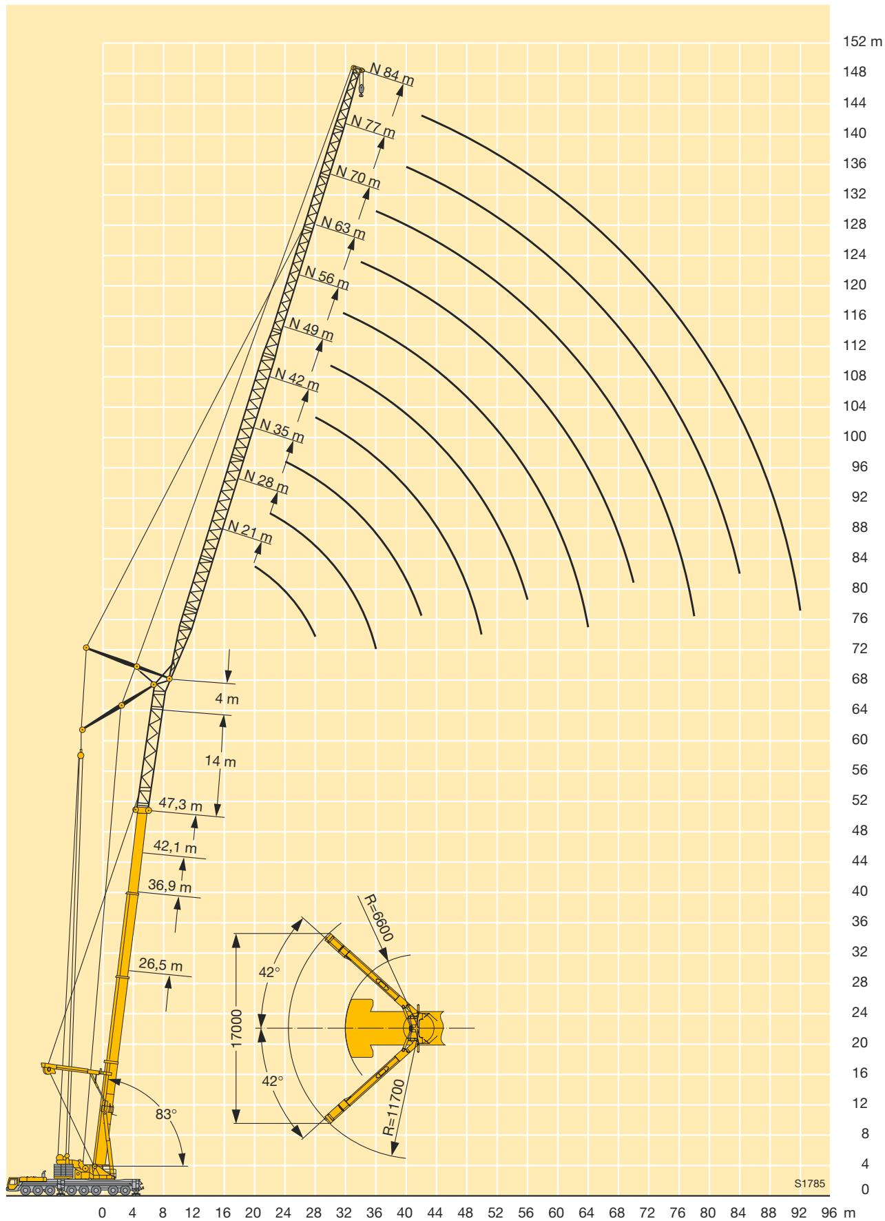
**Traglasten an der wippbaren Gitterspitze mit
