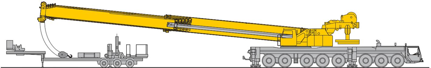
Teleskop 1 bzw. 2 ausfahren bis Verriegelungsbolzen zugänglich.
