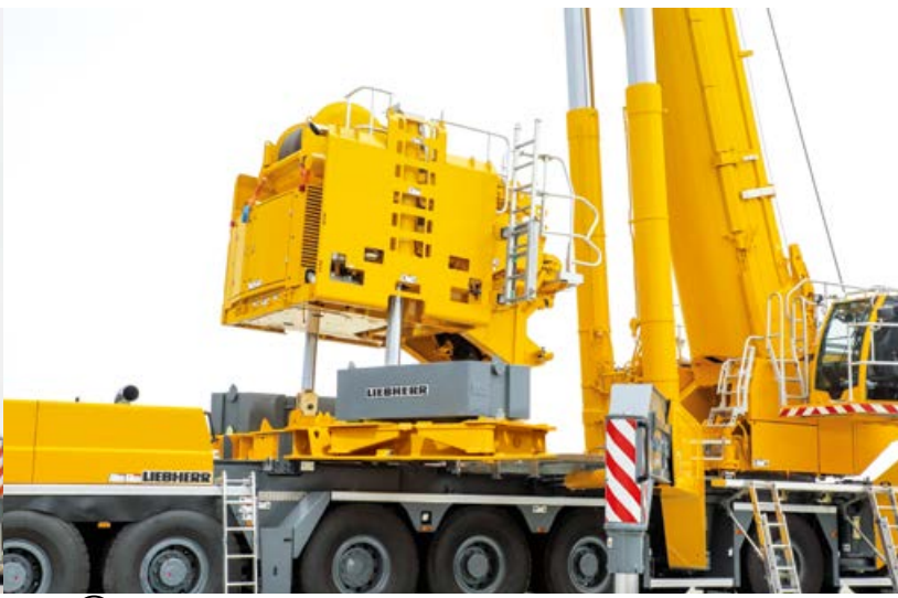
7 Zylinder des Gegengewichtstrahmens auf Ballastgrundplatte fixiert
