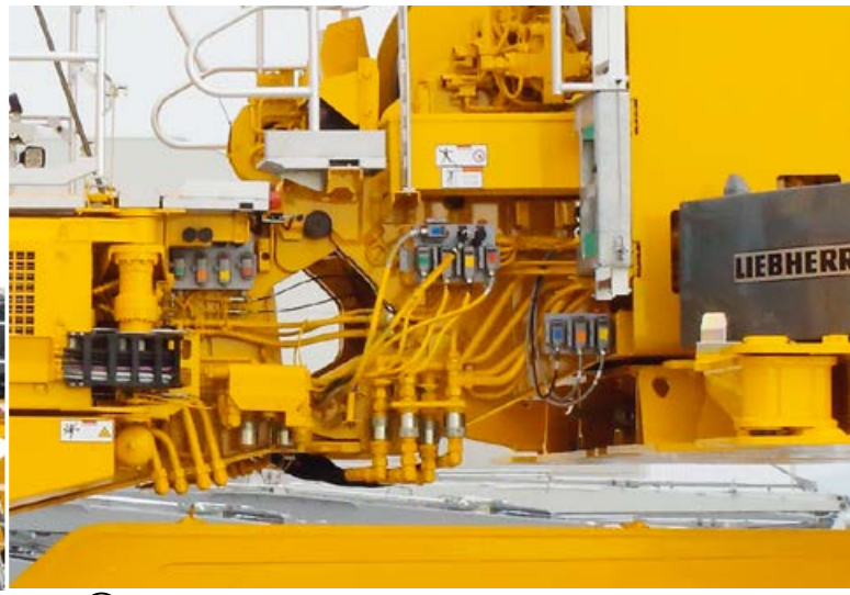
8 Hydraulische und elektrische Schnellkupplungen verbinden
