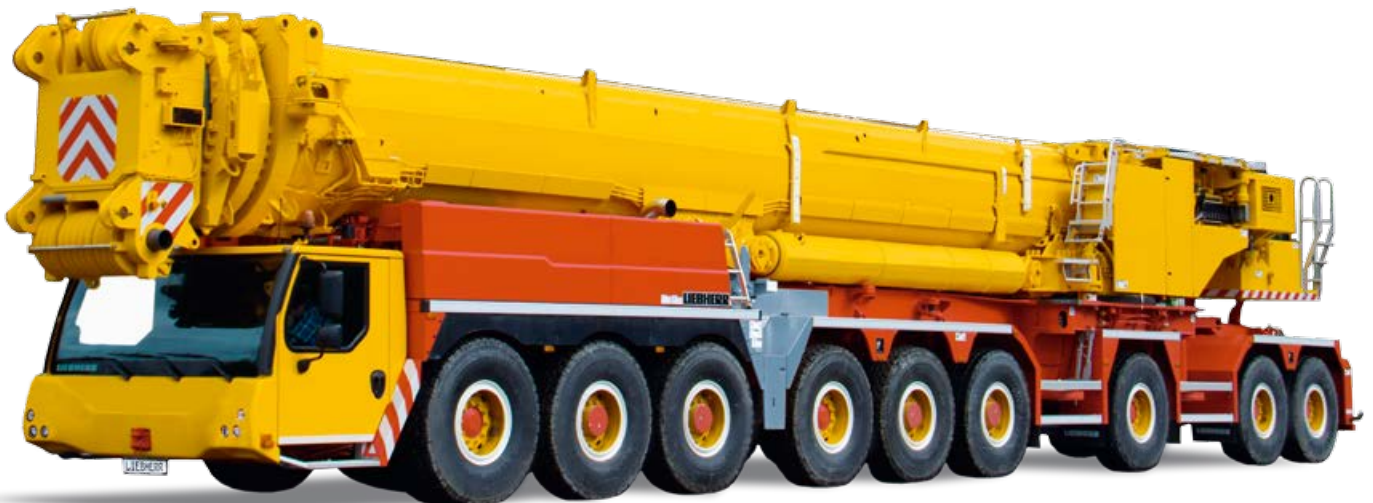
Gesamtgewicht 99 t bei 11 t Achslast ohne Abstützungen
